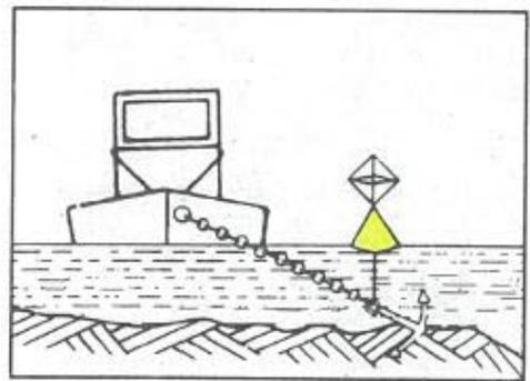
§ 3.26 Fahrzeuge, Schwimmkörper und schwimmende Anlagen, deren Anker die Schifffahrt gefährden können
