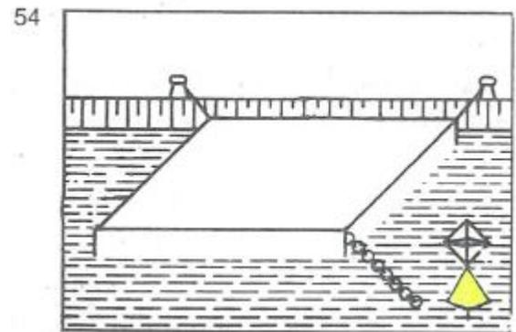
4. Wenn die Anker, Ankerkabel oder Ankerketten schwimmender Geräte die Schifffahrt gefährden können, sind sie zu bezeichnen:
