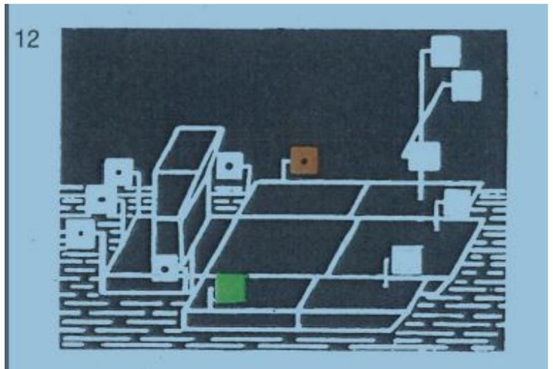
2. Schubverbände, die durch zwei schiebende Fahrzeuge nebeneinander fortbewegt werden, müssen bei Nacht Hecklichter nach Nummer 1 Buchstabe c Ziffer I auf dem steuerbordseitigen schiebenden Fahrzeug führen; das andere schiebende Fahrzeug muß das Hecklicht nach Nummer 1 Buchstabe c Ziffer II führen.
