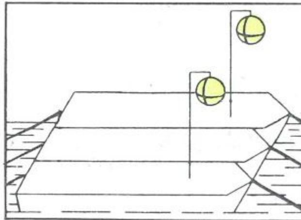
Die Lichter und Bälle aller geschleppten Fahrzeuge eines Verbandes sind so zu setzen, daß sie sich möglichst in gleicher Höhe über dem Wasserspiegel befinden.
