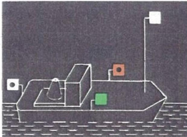
2. Einzeln fahrende Fahrzeuge mit Maschinenantrieb mit mehr als 110,00 m Länge müssen bei Nacht außerdem ein zweites Topplicht führen, und zwar auf dem Hinterschiff und in größerer Höhe als das vordere Licht.
