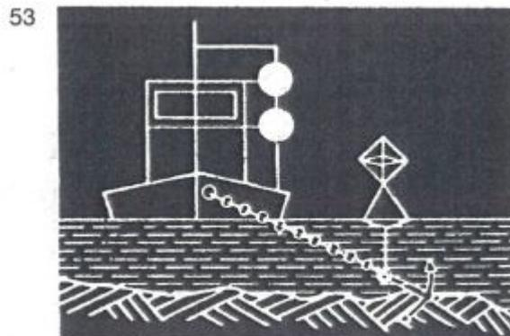
2. Wenn in den Fällen des § 3.23 die Anker so ausgeworfen sind, daß sie die Schifffahrt gefährden können, muß das diesen Anker nächstgelegene Licht ersetzt werden durch zwei von allen Seiten sichtbare weiße gewöhnliche Lichter, die in einem Abstand von etwa 1,00 m übereinander angebracht sind.
