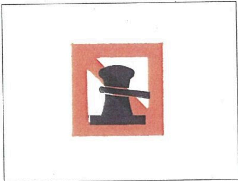
2. Auf den Abschnitten, auf denen das Festmachen am Ufer nach Nummer 1 Buchstabe a verboten ist, dürfen Fahrzeuge und Schwimmkörper sowie schwimmende Anlagen nur auf den Strecken festmachen, die durch eines der Tafelzeichen E.7 oder E.7.1 (Anlage 7) gekennzeichnet sind, und nur auf der Seite der Wasserstraße, auf der das Tafelzeichen steht.
